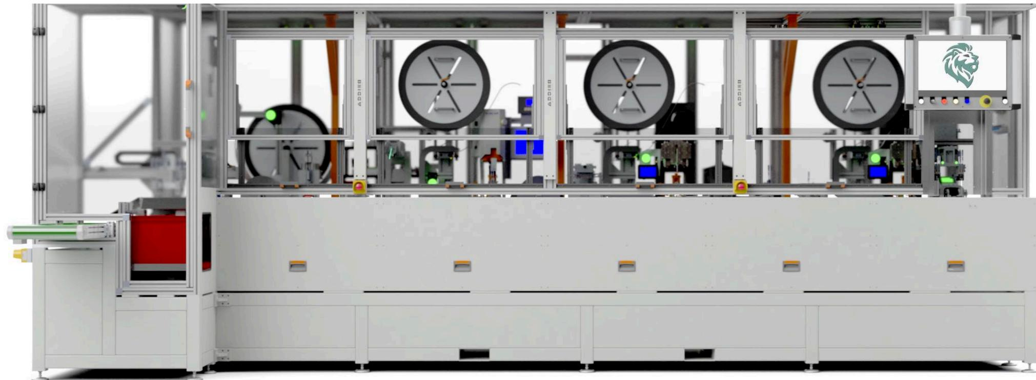
TEILWEISES ABISOLIEREN — ADERENDHÜSENCRIMPEN — MANTEL ENTFERNEN — GEFLECHT BIEGEN — KOAXIALES ABISOLIEREN — MITTELKONTAKTCRIMPEN UND PRÜFEN — BÜRSTEN — DURCHGANG PRÜFEN — ÄUSSERE KONTAKTCRIMPEN — SCHNITTSTELLENADAPTER CLINCHEN UND PRÜFEN — TIEFENPRÜFUNG — SCHLECHTE TEILE ABSCHNEIDEN UND KABELN LADEN
