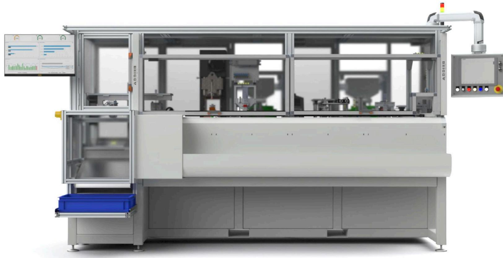
Nullpositionierung → Einsetzen der Aderendhülse → Biegen des Geflechts → Abisolieren → Einsetzen des Außenkontakts → Crimpen des Außenkontakts → Tiefenprüfung und Kamerasteuerung → Ausschneiden schlechter Teile und Entladen
